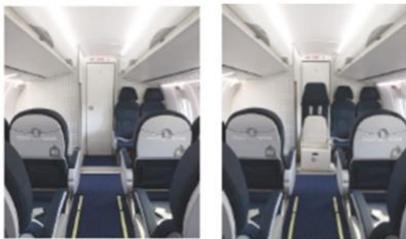
Assento recolhido e estendido. Há uma alavanca de destravamento para estendê-lo.
